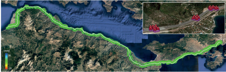
Résultats d'une étude Atlas InSAR sur une autoroute de 200 km présentant le mouvement cumulé sur une période de 2 ans. Vue détaillée sur une zone affectée par des désordres.
